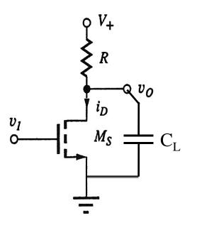
$$v_o = v_{DS} = V_{DD} - i_D R$$
