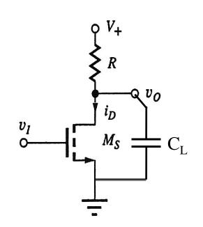
$$v_o = v_{DS} = V_{DD} - i_D R$$
