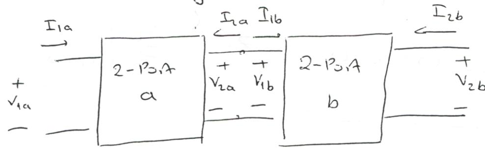
$$\begin{bmatrix} V_{1a} \\ I_{1a} \end{bmatrix} = \begin{bmatrix} A_a & B_a \\ C_a & D_a \end{bmatrix} \begin{bmatrix} V_{2a} \\ -I_{2a} \end{bmatrix}, \quad \begin{bmatrix} V_{1b} \\ I_{1b} \end{bmatrix} = \begin{bmatrix} A_b & B_b \\ C_b & D_b \end{bmatrix} \begin{bmatrix} V_{2b} \\ -I_{2b} \end{bmatrix}$$
