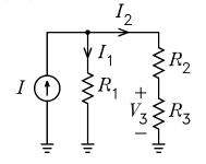
$$I_{1} = 250 \,\mu A \frac{68 \,\mathrm{k}\Omega + 82 \,\mathrm{k}\Omega}{100 \,\mathrm{k}\Omega + 68 \,\mathrm{k}\Omega + 82 \,\mathrm{k}\Omega} = 150 \,\mu A$$
